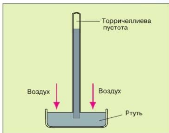
Рис. 95. Барометр Торричелли и принцип его действия
